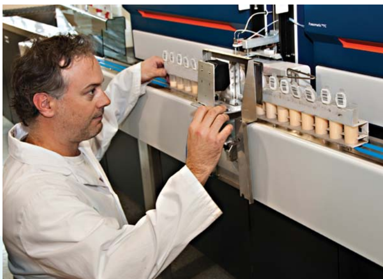
Analyseur à infra-rouge qui analyse des échantillons de contrôle laitier.
